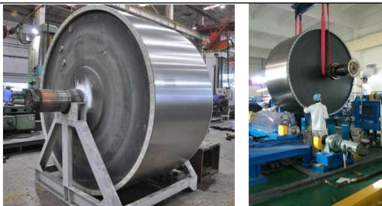
图 19：阴极辊在铜箔生产流程中的作用
