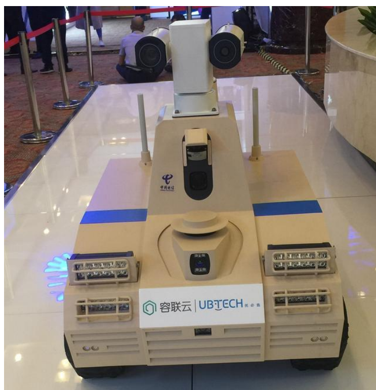
图 41 5G 安防巡检机器人示例
