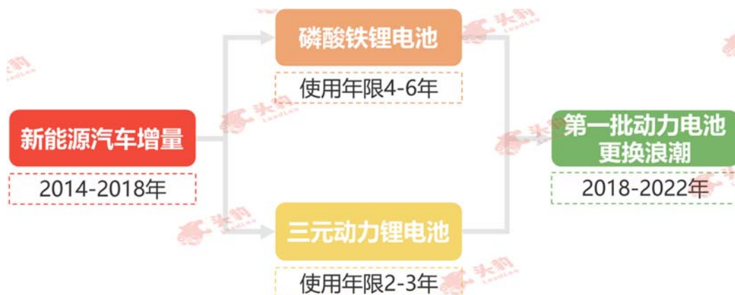
图 3-2 中国新能源汽车动力锂电池更换周期
