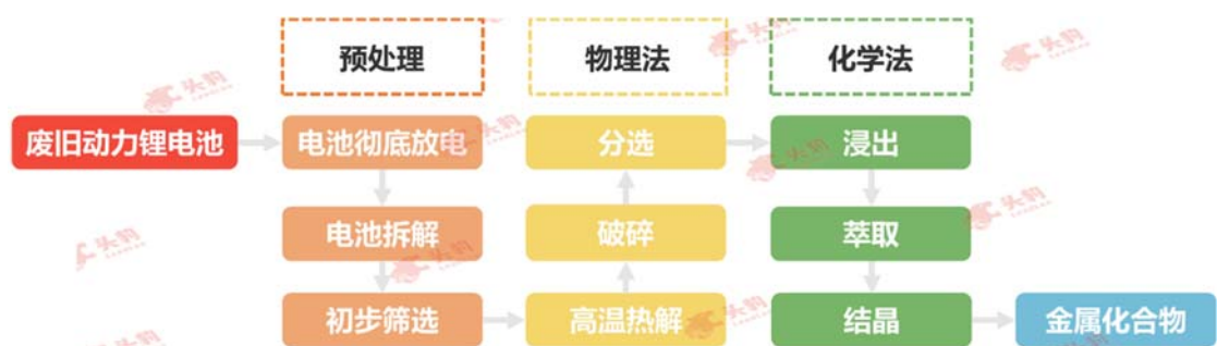
图 2-4 物理法和化学法在再生利用模式下的应用
