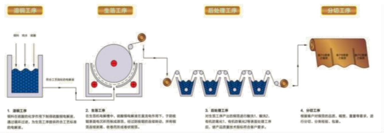
图表30 锂电铜箔的生产流程图
