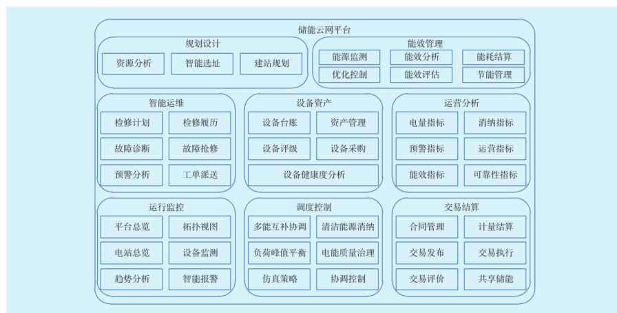
图 12：储能云网平台功能架构
