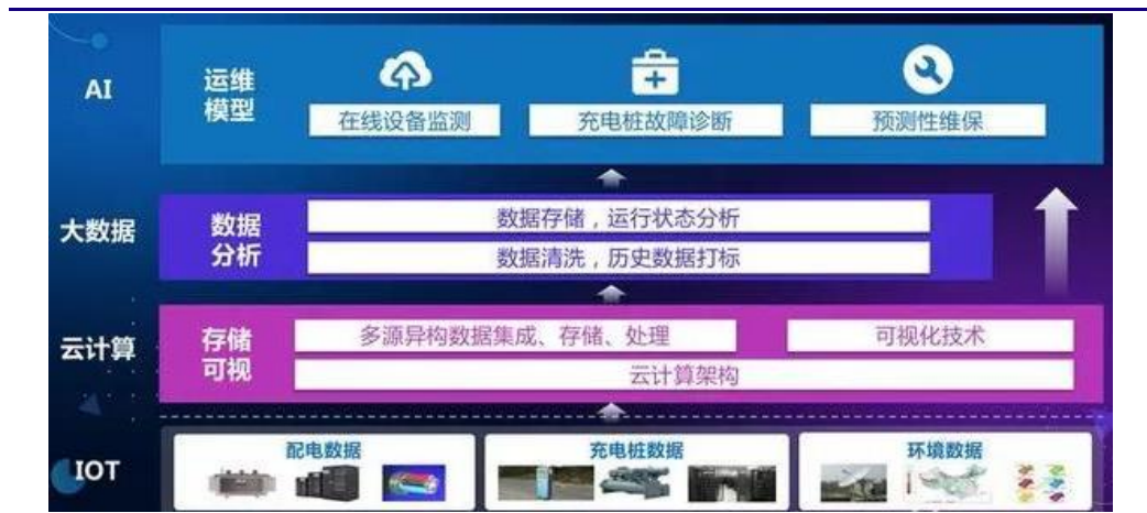
图 33：充电桩智能管理运维系统架构
