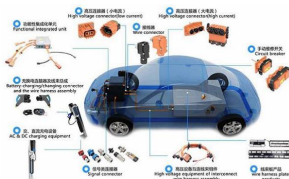
图 16: 连接器在整车系统中的应用概览
