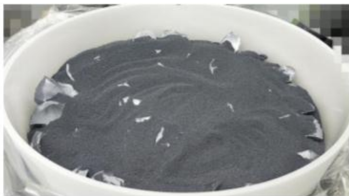
图 9：FBR 颗粒硅—流动性好、免破碎、满足复投需求，且具有良好填充性、有效提升拉晶效率
