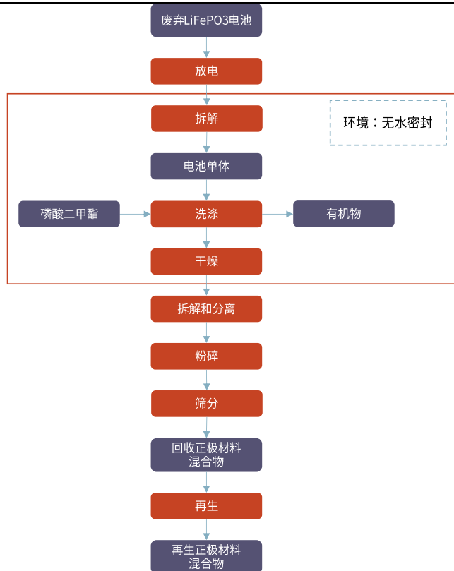
图 19：废旧磷酸铁锂电池回收和再生流程图
