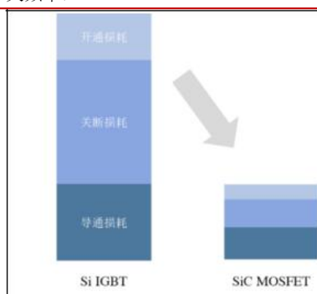
图 18：硅基 IGBT 与 SiCMOSFET 对比（40kHz 开关频率）
