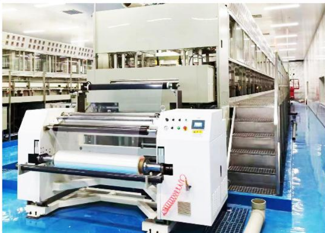
双边夹卷式水平连续镀膜设备
