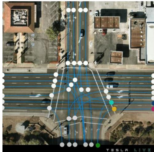
图：特斯拉参考自然语言模型中的Transformer decoder，以序列的方式自回归地输出车道线节点
