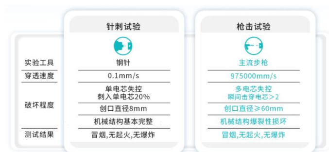
图 3：弹匣电池 2.0 可实现枪击不起火
