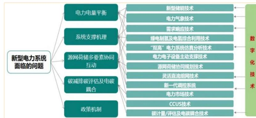
图. 新型电力系统面临的问题及解决方案
