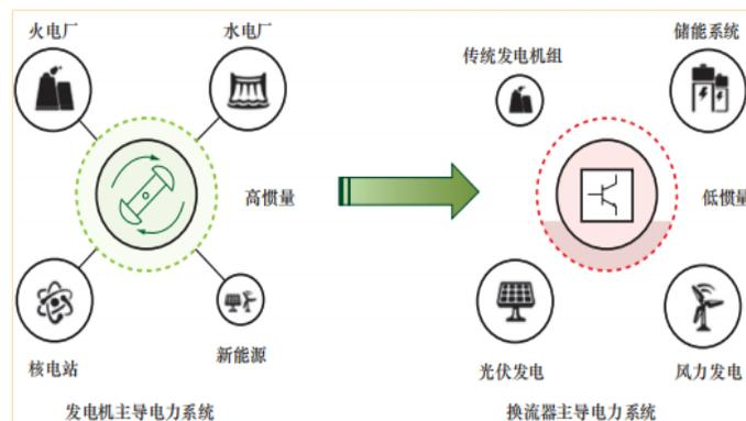
图. 新型电力系统与传统电力系统对比
